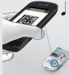
Richten Sie die Kamera des Diabetes Managers auf den Kopplungscode der Pumpenbasis. Halten Sie den Diabetes Manager dabei so, dass der Kopplungscode vollständig erfasst wird. Wenn der Kopplungscode erkannt wurde, wird ein Ton ausgegeben und die Aufforderung zum Füllen der Reservoir-Nadel wird angezeigt.
