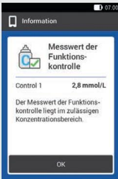
Liegt der Messwert im zulässigen Konzentrationsbereich bedeutet dies, dass der Diabetes Manager und die Teststreifen ordnungsgemäß funktionieren.
