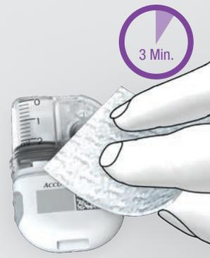
Entfernen Sie grobe Verunreinigungen mit einem fusselfreien, mit destilliertem Wasser angefeuchteten Tuch.
