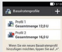
Das geänderte Basalratenprofil wird in der Übersicht der vorhandenen Basalratenprofile angezeigt.
