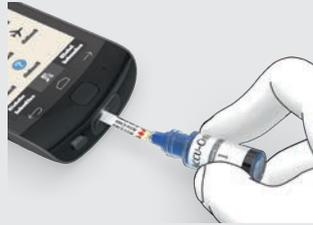
Drücken Sie die Flasche zusammen, bis sich an der Flaschenspitze ein kleiner Tropfen bildet. Berühren Sie mit dem Tropfen den gelben Rand des Teststreifens. Tragen Sie die Kontrolllösung nicht auf die Oberseite des Teststreifens auf.
