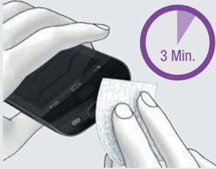
Entfernen Sie grobe Verunreinigungen mit einem fusselfreien, mit destilliertem Wasser angefeuchteten Tuch.
