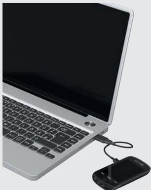
Stecken Sie den größeren Stecker (USB Typ A) des USB-Kabels in einen freien USB-Ladeanschluss Ihres Computers. Der USB-Ladeanschluss ist oftmals durch ⚡ gekennzeichnet.
