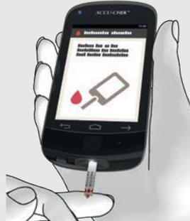
Berühren Sie mit dem Blutstropfen den vorderen gelben Rand des Teststreifens. Tragen Sie das Blut nicht auf die Oberseite des Teststreifens auf.
