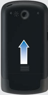
Öffnen Sie das Akkufach, indem Sie den Akkufachdeckel in Pfeilrichtung nach oben schieben.
