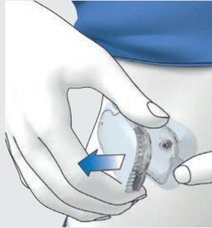
Drücken Sie auf die Lasche zum Ablösen der Mikropumpe und nehmen Sie die Pumpe von der Infusionseinheit ab.
